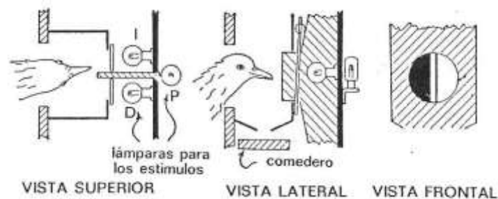
FIGURA 22. Ilustración esquemática del sujeto y el aparato utilizados en la investigación de Blough. La vida frontal muestra uno de los cuatro esquemas de estímulo posibles. (De Blough, 8.)
